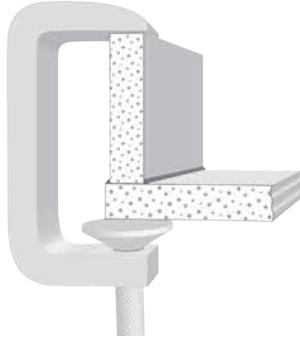
Kod Kerrock ploča, koje sadrže metalne čestice (metalni efekat, luminaco S) i mermer, izgled površine i ivice ploče razlikuju se, zato spojeve treba uraditi tako da ivica ploče nije vidljiva. Na raspolaganju su nam dva načina:
