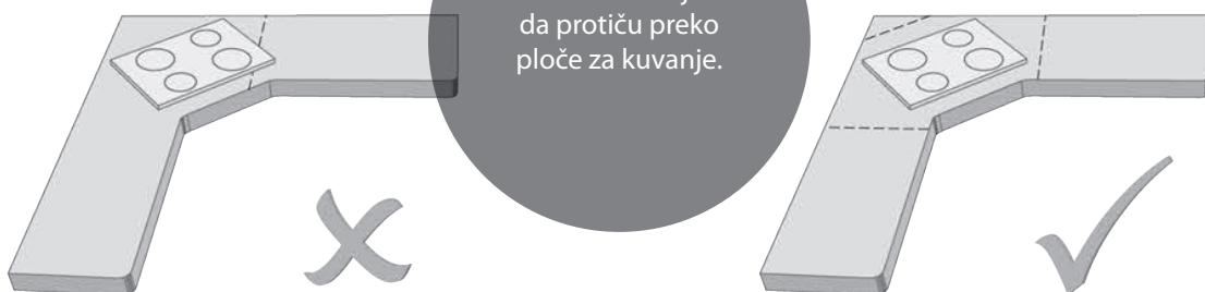
Isečena ivica mora da bude ravna i glatka, bez okrnjenih ivica, pošto će samo takva da obezbedi nevidljivo spajanje. Ivice su potencijalno slabe tačke gde mogu da nastanu pukotine. Prilikom planiranja sečenja moramo da poštujemo minimalni radijus od 6 mm, jer pravougaoni unutrašnji spojevi takođe predstavljaju rizične tačke, gde mogu da nastanu pukotine.
