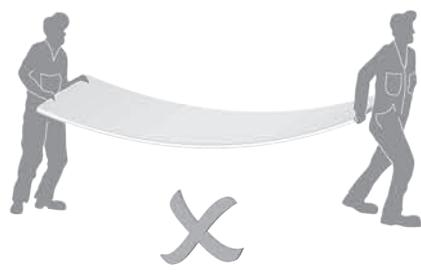
Ploče moraju da se prenose svaka posebno i to vertikalno, jer jedna ruka služi za pridržavanje, a druga za nadzor. Preporučuje se korišćenje vakuumskih pomagala za prenos tereta.
